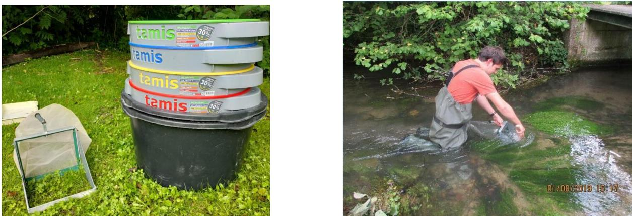
*Figure 8 : Matériel (Sorber et tamis) et méthode utilisée pour les prélèvements I2M2*
