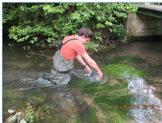
Photographie 2 - Filet de type Surber (gauche) et technique de prélèvement (droite)
