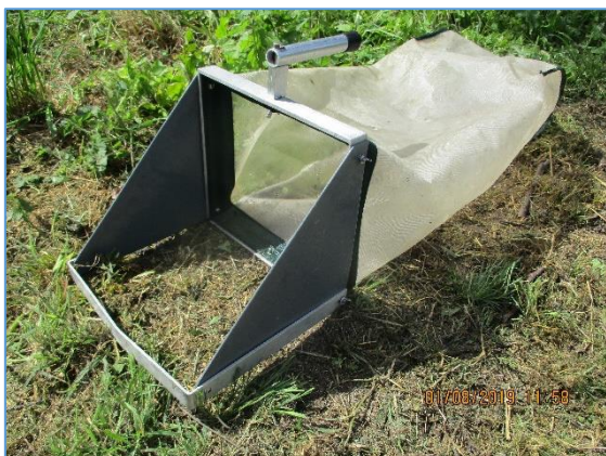
Photographie 2 - Filet de type Surber (gauche) et technique de prélèvement (droite)
