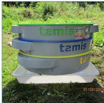
Photographie 2 - Tamis superposés utilisés pour filtrer les échantillons et récolter les invertébrés prélevés
