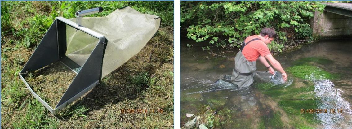
Photographie 1 - Filet de type surber (à gauche) et technique de prélèvement (à droite)
