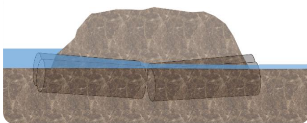
Avant travaux : 2 séries de busages mal calibré faisant obstacle à la continuité
