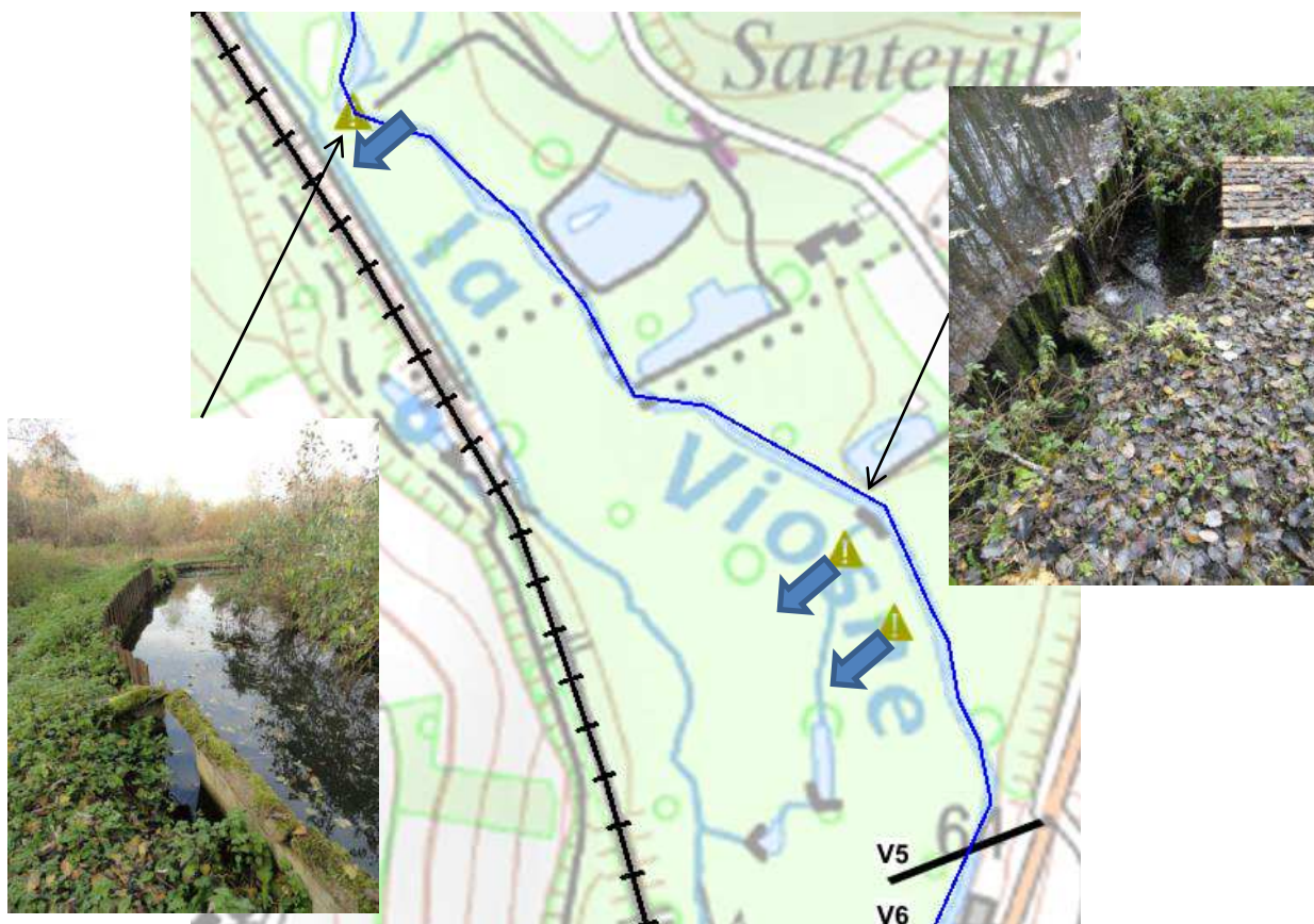
Figure 62 : Ecoulements secondaires initiés par la formation de renards hydrauliques
